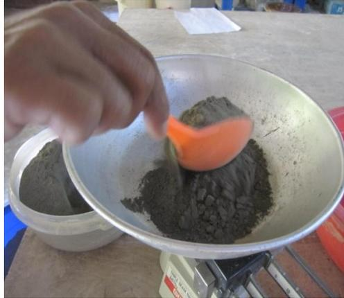
**Gambar 4.** Proses Penimbangan Komposisi Lumpur Lapindo dan Abu Gunung Merapi.
