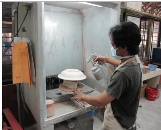
**Gambar 14.** Proses Pengglasiran *Prototype* Produk.
