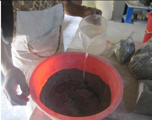
**Gambar 5.** Proses Pembuatan Adonan Lumpur Lapindo dan Abu Gunung Merapi.
