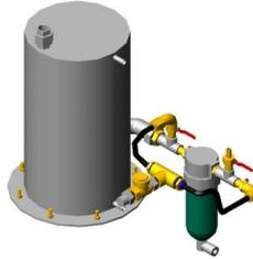
Gambar 2. Penampung Kondensat untuk Pendugaan Kadar Air
