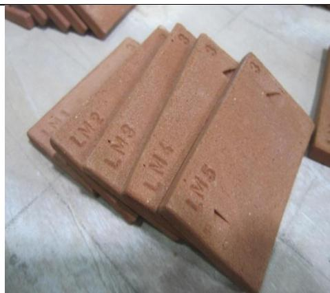
**Gambar 8.** Contoh Tile Uji Campuran Lumpur Lapindo dan Abu Gunung Merapi yang Selesai Dibakar.
