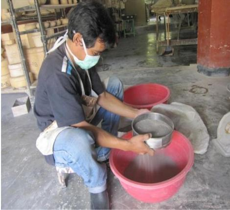
**Gambar 3.** Proses Penyaringan Lumpur Lapindo
