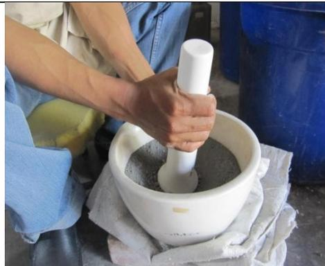
**Gambar 2.** Proses Penumbukan Lumpur Lapindo.
