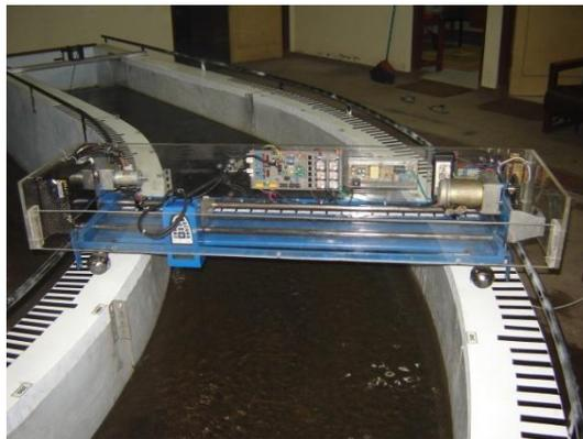
Gambar 1. Model alat ukur elevasi muka air dan elevasi dasar flume otomatis
