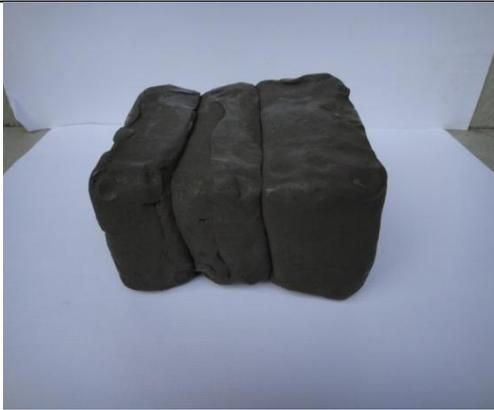
**Gambar 9.** Hasil Pengulian Adonan Lumpur Lapindo dan Abu Gunung Merapi Yang Siap untuk Dibuat *Prototype* Produk.
