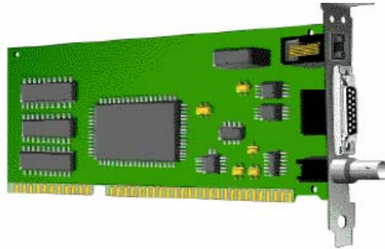
Gambar Kartu Jaringan Ethernet Dari Atas Ke Bawah : konektor RJ-45, konektor AUI, dan konektor BNC
