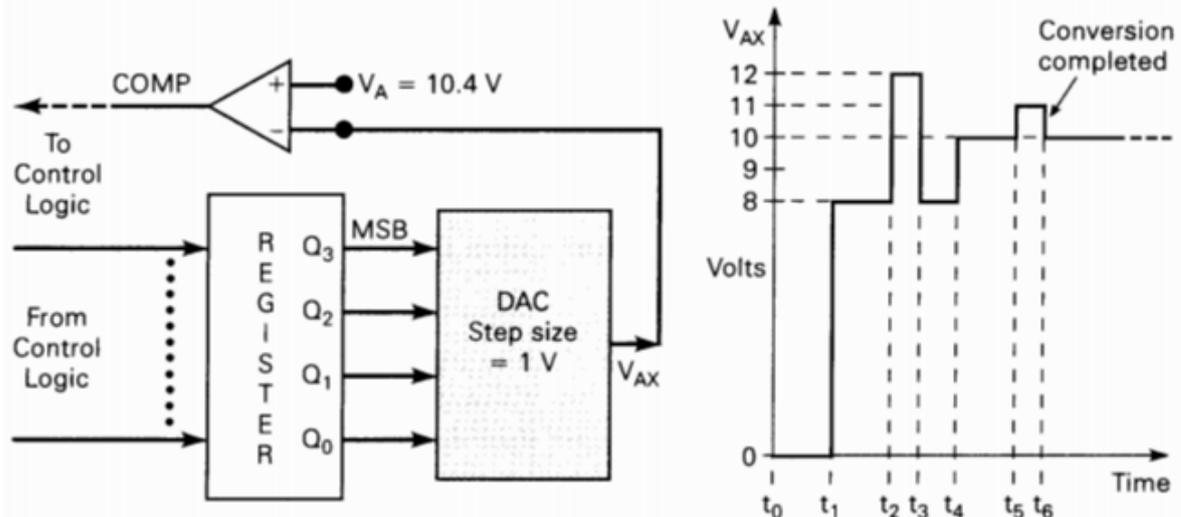
Gambar 7. Contoh operasi DAC *Successive-approximation* dengan *step size* 1 V,  $V_A=10,4$  V, dan keluaran digital  $1011_2 = 11_{10}$
