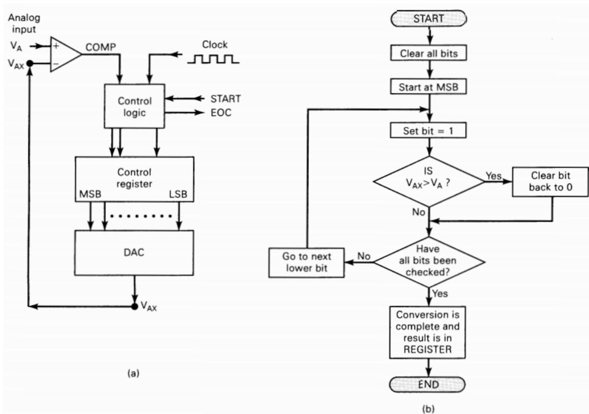
Gambar 6 DAC *Successive-approximation* (a) Diagram blok yang disederhanakan
