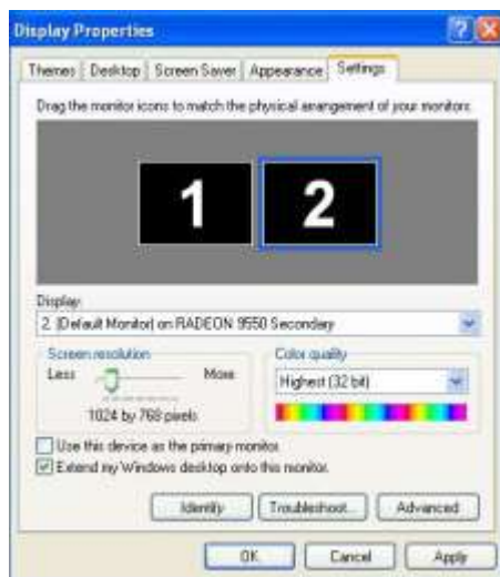
Gambar 3. Seting untuk penggunaan dual monitor
