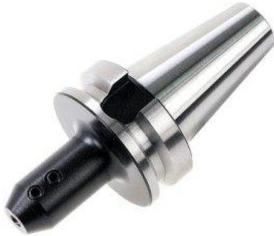
Salah satu jenis Arbor yang digunakan untuk mencekam Cutter dengan tangkai silindris, dimana prinsip pengekamannya cukup sederhana dengan mengencangkan screw yang ada pada arbor, sehingga screw tersebut menekan cutter dan mengikatnya, untuk itu perlu ada bidang rata pada sisi tangkai cutter, agar bisa tercekam dengan baik.
