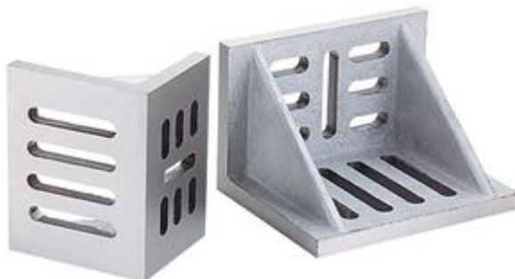
Ketika permukaan benda kerja yang akan di milling memiliki atau ingin dibuat sudut tertentu, maka dapat dibuat dengan menggunakan angle plate. Benda kerja yang dipasang pada angle plate, biasanya dicekam dengan menggunakan clamp.
