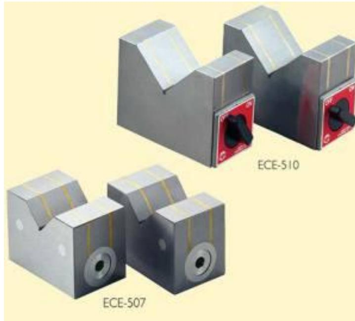
V-blocks sangat baik digunakan untuk pencekaman batang poros yang akan di proses milling, batang poros yang pendek biasanya ditempatkan pada sebuah V-blocks saja, jika batang porosnya panjang, dua buah V-blocks atau lebih dipasang pada meja mesin, dengan jarak yang sesuai dengan panjang batang poros. V-blocks dan benda kerja dicekam pada meja mesin dengan menggunakan clamp.
