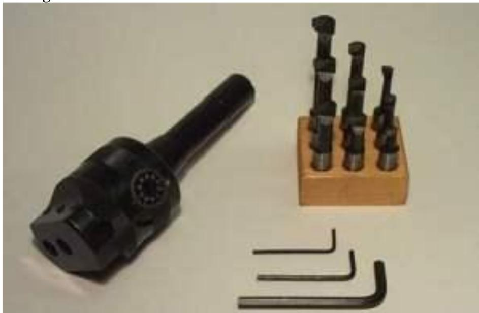
Digunakan untuk mencekam boring tools, dimana dalam boring head biasanya disertai skala yang cukup teliti untuk pembuatan lubang yang memiliki ukuran presisi.
