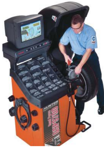
Gambar 73. Pemasangan roda pada mesin balance
