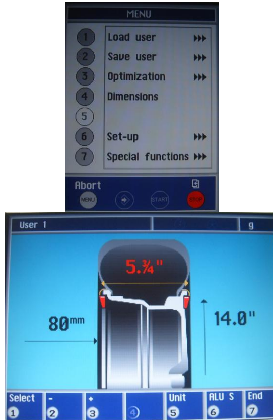
Gambar 76. Proses input data diameter, lebar pelek serta jarak roda dari mesin
