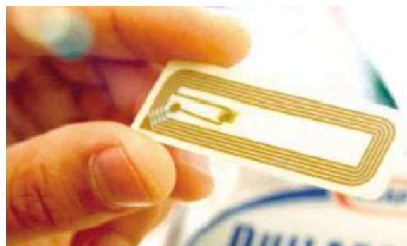
Gambar 2. RFID tag dengan silikon chip dan antena eksternal.
