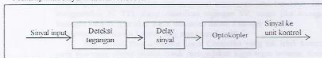
Gambar 3. Blok Diagram Modul Input
