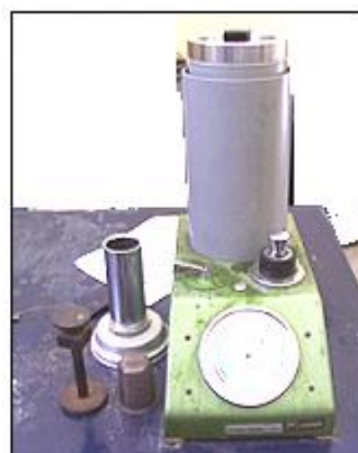
Gambar 5.15. Alat uji permeabilitas
