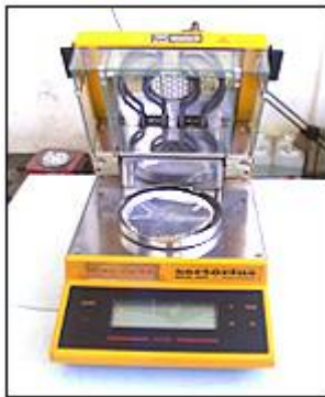
Gambar 5.12. Moisture analyzer type MA 30
