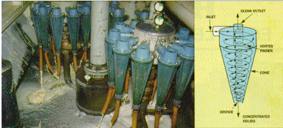
Gambar 6.5. Peralatan centrifuing untuk cairan pendingin
